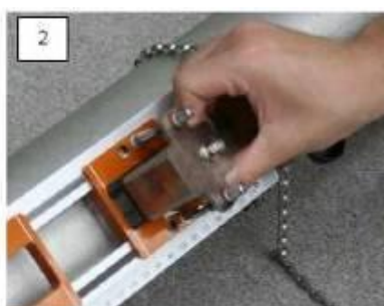
Figura / Figure 8 Montaggio della struttura sul tubo Set mounting fixture onto the pipe.
