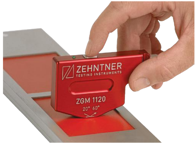
Gloss measurements of a coating / Glanzmessung einer Beschichtung
